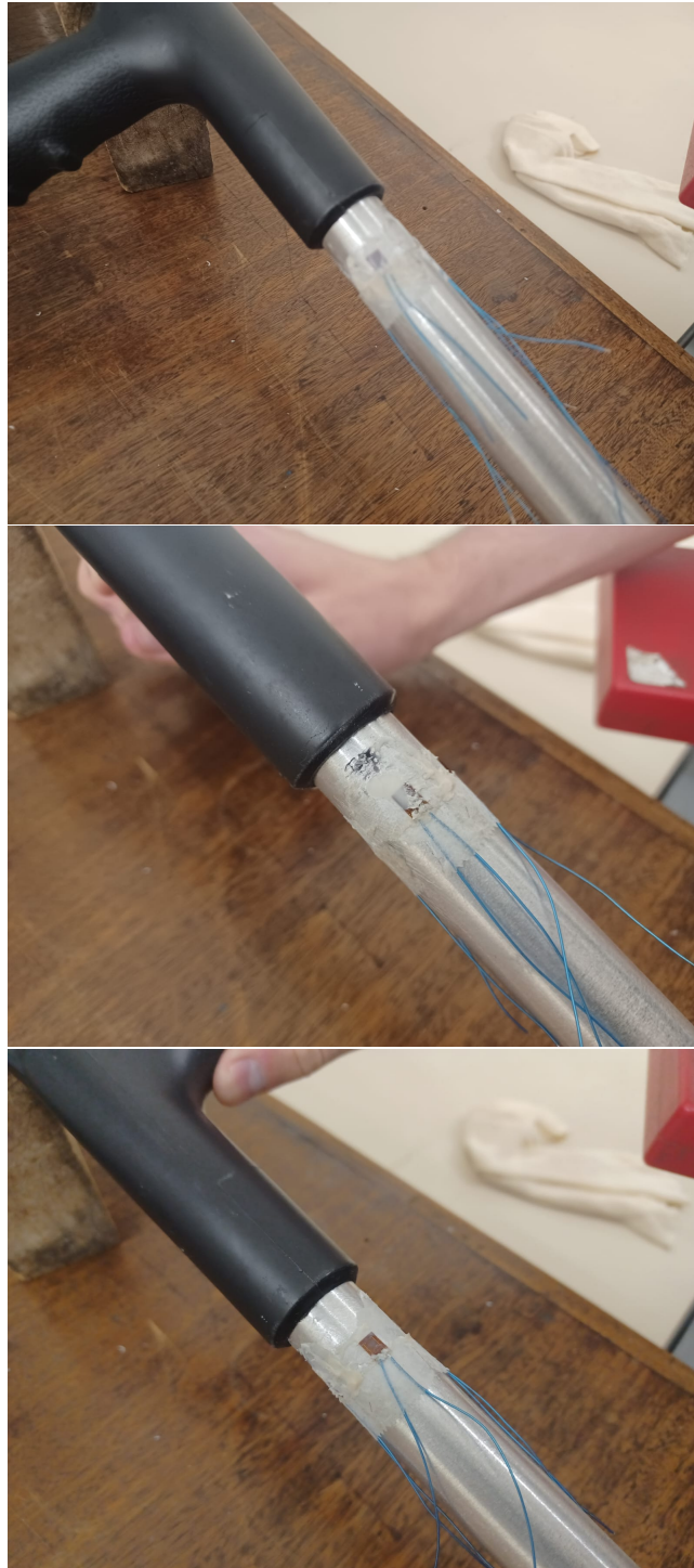
Figura 16: Muleta após colagem dos extensômetros e solda de seus fios
