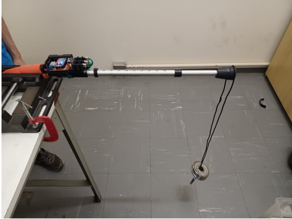
Figura 19: Ensaio de calibração dos esforços F_x da Muleta
