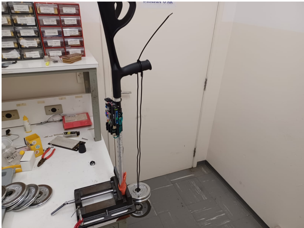
Figura 20: Ensaio de calibração dos esforços F_z da Muleta
